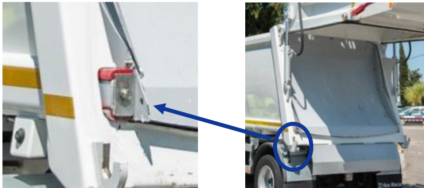
Placa eyectora con detalle rail lateral con patín
