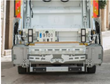
Elevador polivalente en posición inferior
