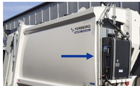
Vista lateral del depósito de aceite
