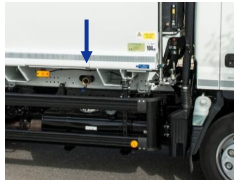
Vista exterior de la manguera de drenaje
