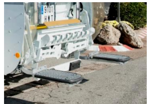
Estribas con detector de peso
