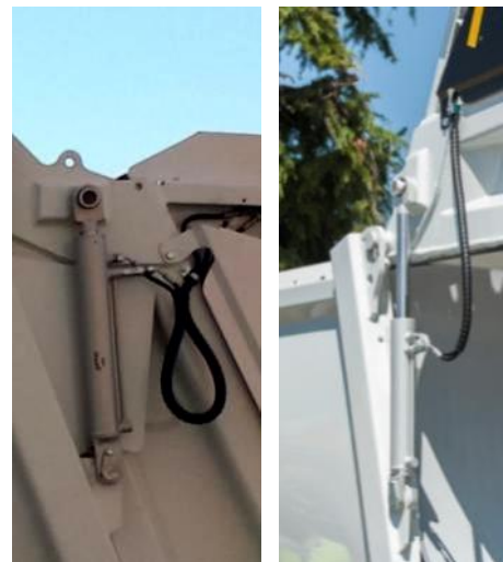
Cilindro de elevación totalmente cerrado / abierto
