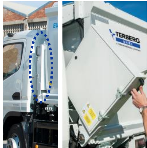
Quadro elétrico na parte dianteira, rebatido
