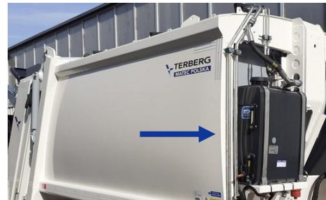
Vista lateral do reservatório de óleo
