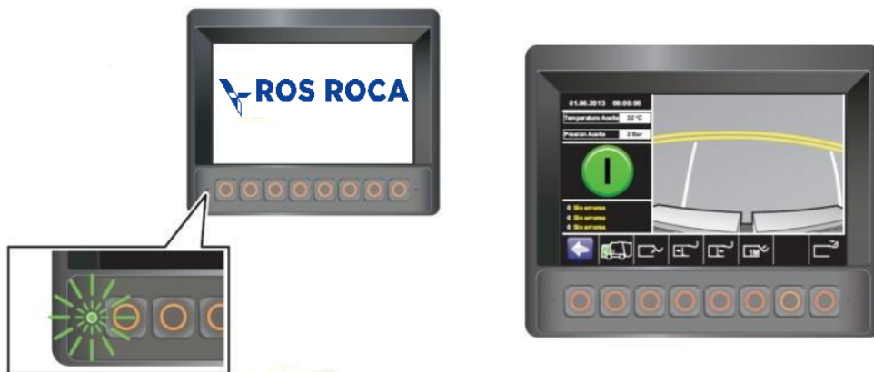
Painel de controlo a cores dentro da cabina
