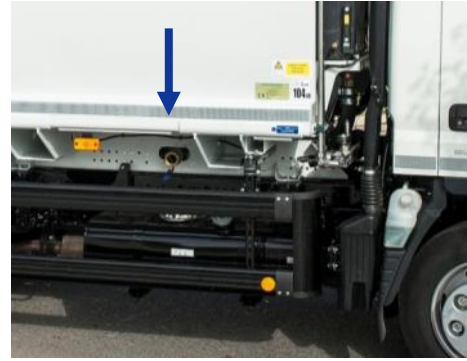
Vista exterior da mangueira de drenagem
