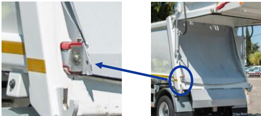
Placa ejetora com detalhe da calha lateral com patim
