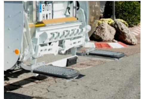
Estribos com sensor de peso
