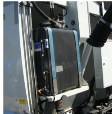
Reservatório de óleo na parte dianteira da caixa
