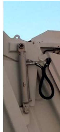
Cilindro de elevação totalmente fechado/aberto
