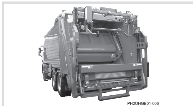
Rys. 1-4 Otwarty mechanizm zasypowy pojemnika na odpady
