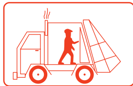
BEI LAUFENDEM MOTOR DEN AUFBAU BETRETEN
